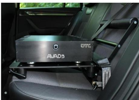
Die Halterung wird in die genormten Kindersitz-Halterungen (ISOFIX) eingeklinkt und dann mit definiertem Anpressdruck in den Sitz verspannt. Die erfolgreich crashgetestete Halterung gewährleistet einen sicheren Testbetrieb, auch bei sehr hohen Bremsverzögerungen, wie sie typisch für AEB-Tests sind.
